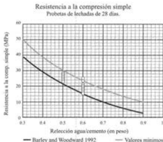
FIGURA 35 A. RESISTENCIA A LA COMPRESIÓN SIMPLE DE PROBETAS DE LECHADAS.
